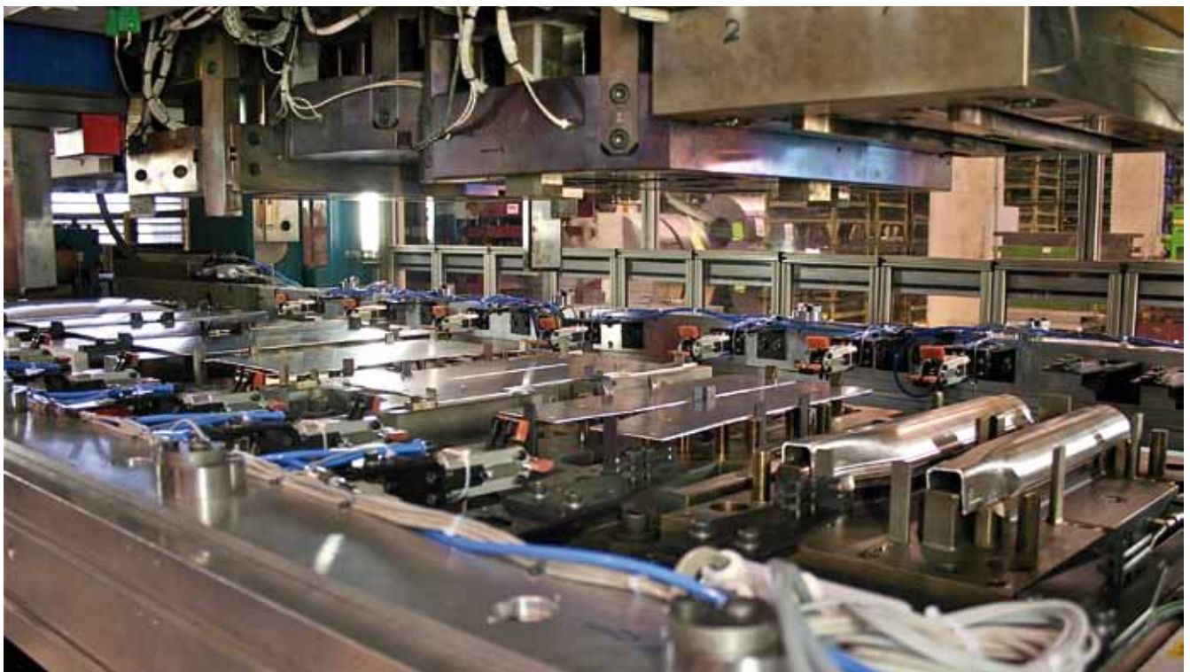
Das Transferwerkzeug kommt auf konventionellen Serienpressen zum Einsatz.
