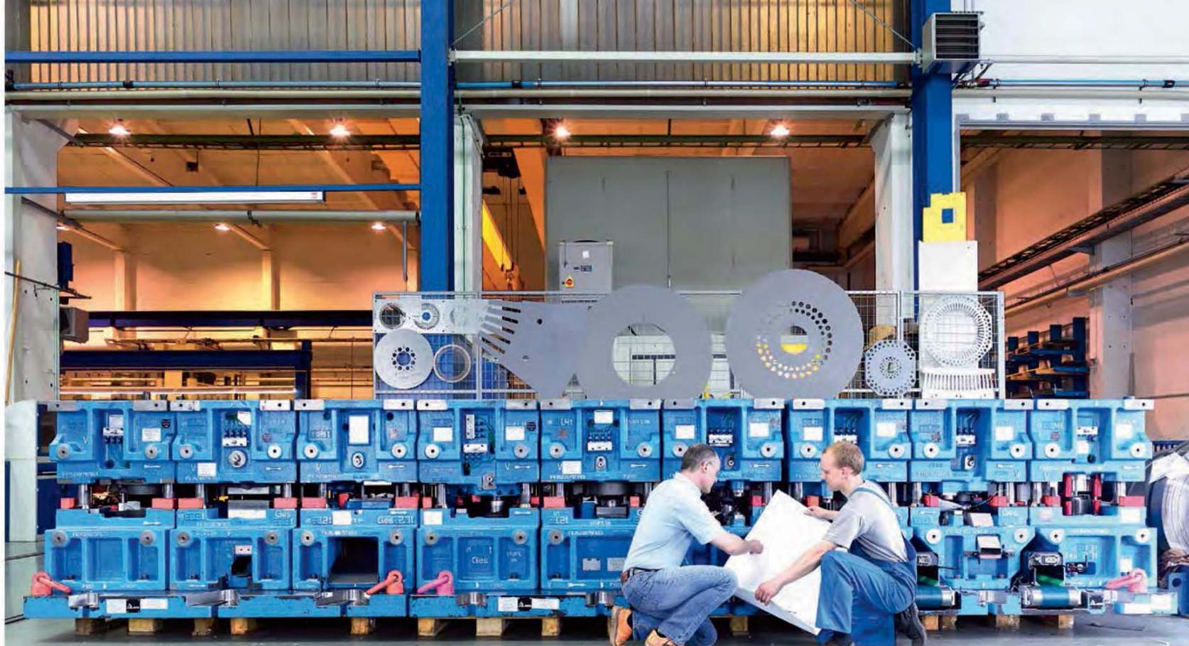
Für hochpräzise Getriebekomponenten kann Aweba mit der Kombination aus Umformen und Feinschneiden in einem Werkzeugsatz noch heute ein weltweit einmaliges Know-how bieten. Bilder: Aweba
